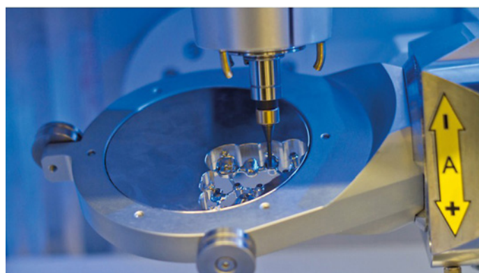
Fot. 2. Obróbka symultaniczna w 5 osiach na frezarce firmy imes-icore CORiTEC typu 350i
