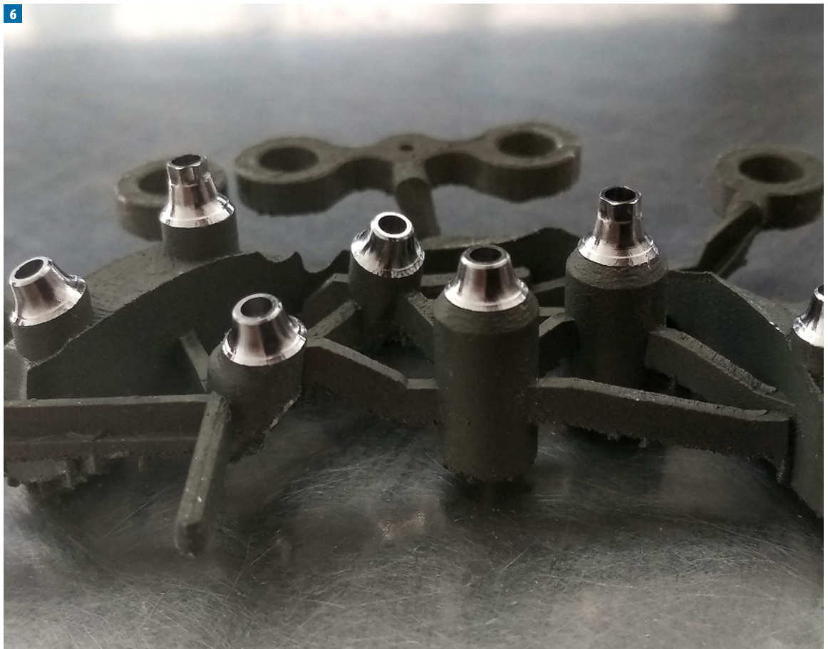
Ryc. 6. Belka z wykończonymi interfejsami implantologicznymi (tzw. interfejsy) w systemie Astra 3.5 bez antyrotacji zamocowana w strukturze „sieci” po wyjęciu z frezarki
