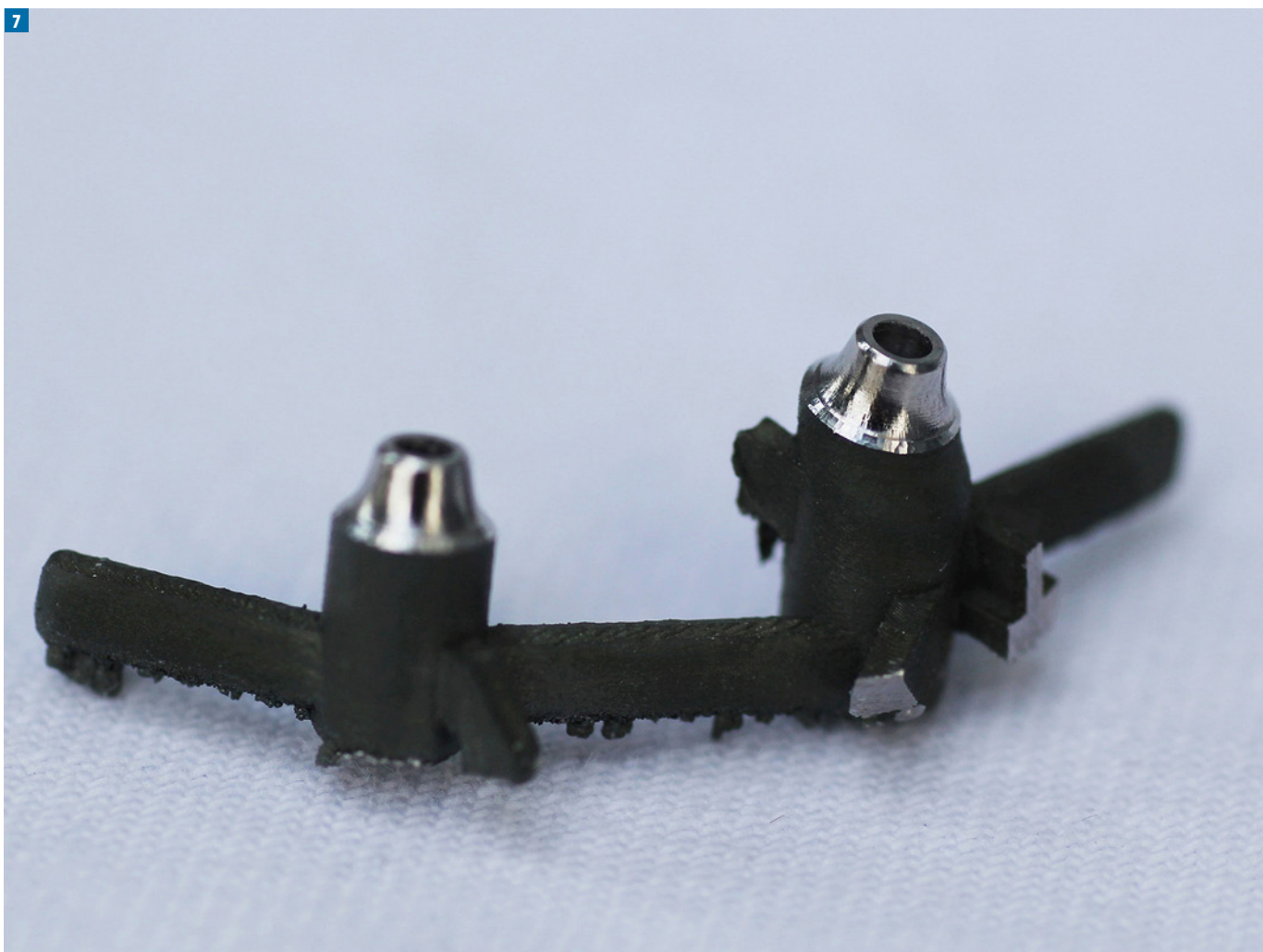
Ryc. 7. Belka z wykończonymi interfejsami implantologicznymi w systemie Astra 3.5 bez antyrotacji, po odcięciu podpór (fotografia wykonana przez Dental Lab Laboratorium Dentystyczne)
