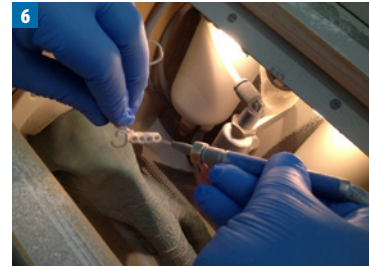
Fot. 3. Wyfrezowany szkielet we wnętrzu frezarki CORiTEC 250i
