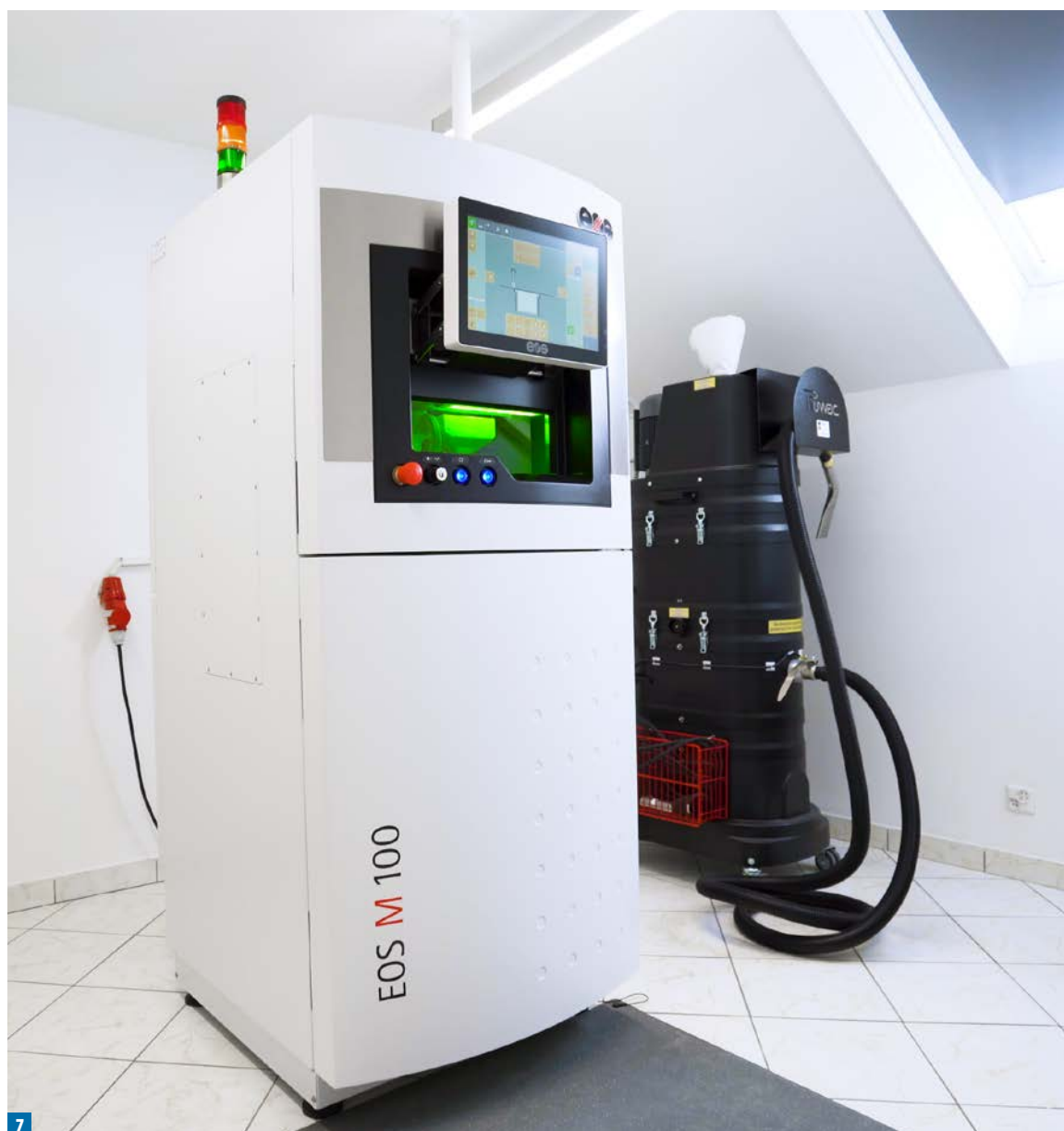
Ryc. 7. Drukarka DMLS EOS M100 pracująca z materiałem EOS Titanium Ti64 ELI
