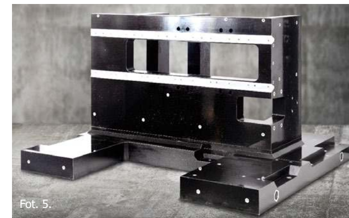
Fot. 5. Przykład konstrukcji ramy nośnej frezarki CORITEC 350i PRO® wykonanej z polimerobetonu zapewniającej dużą sztywność oraz minimalizującą efekt termo-rozszerzalności
